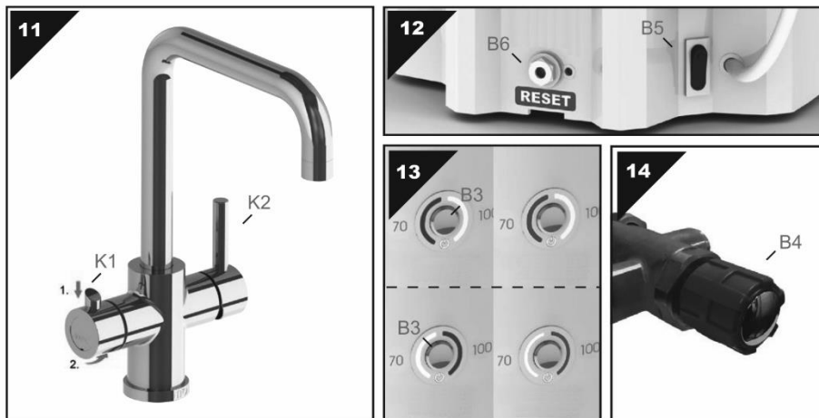
Рис. 9. Эксплуатация смесителя со смесительным клапаном
