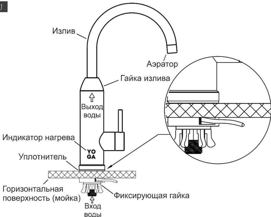
Рис. 2. Установка с выводом кабеля питания под мойкой
