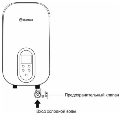
Рис.3 Установка предохранительного клапана
