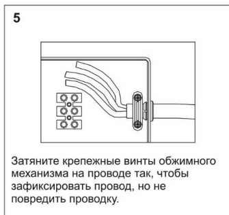
Рис.4 Подключение кабеля питания
