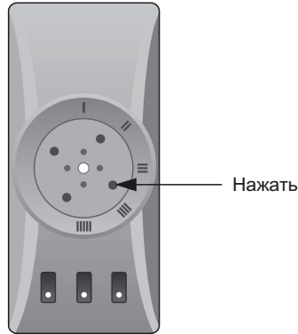
Рис. 3. Расположение штока на термовыключателе термостата.
